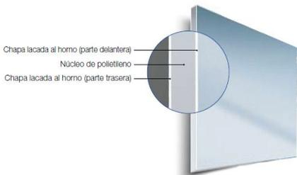
Compuesto por dos capas de aluminio y un núcleo de polietileno de baja densidad. El aluminio visto es tratado con una pintura especial para mantener el color y evitar que se deteriore con el correr del tiempo. Debido a que es ligero, ofrece una reducción de las cargas aplicadas a la estructura de la obra, disminuye las secciones de vigas, columnas y fundaciones.
